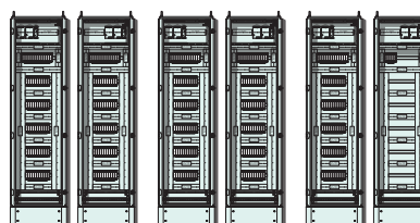
Шкаф №1 кроссовый 600x2000x800 114 модулей Шкаф №2 кроссовый 600x2000x800 114 модулей Шкаф №3 кроссовый 600x2000x800 60 модулей
